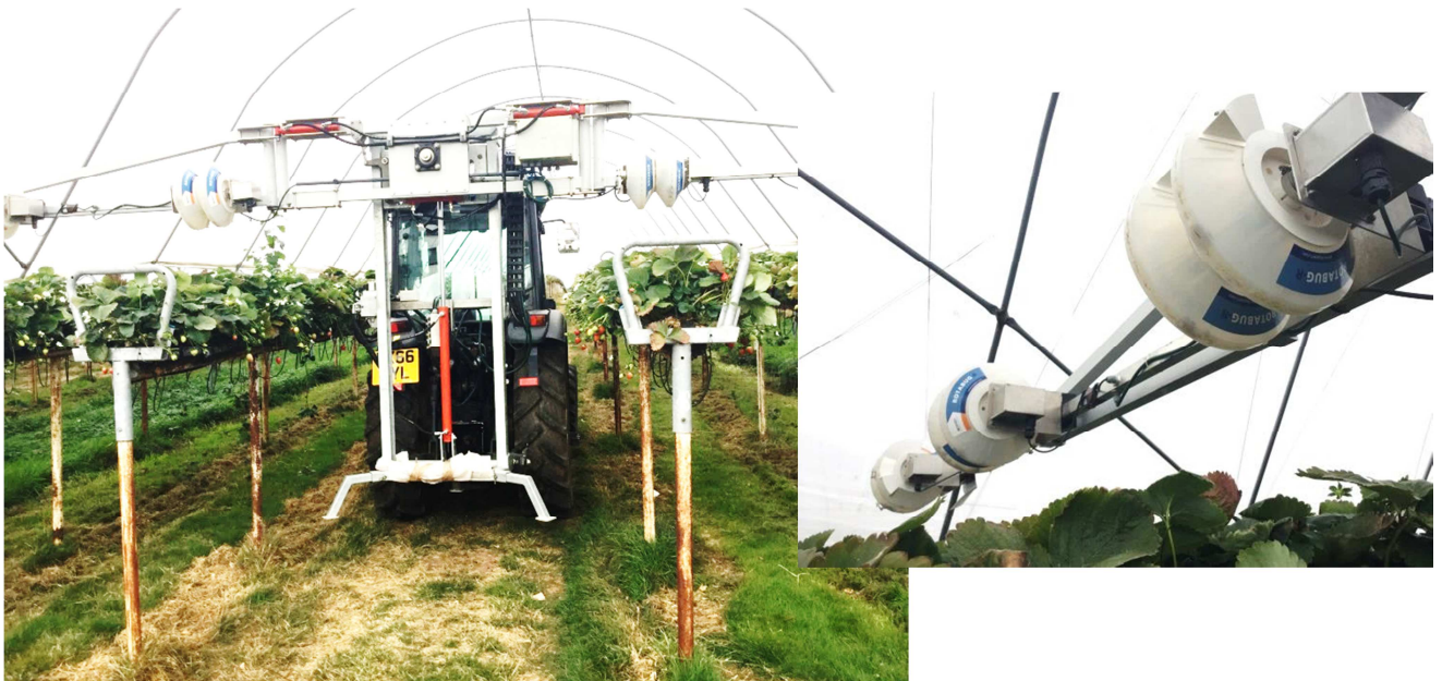
Kuva 29. Tilalla on testattu biologisten petopunkkien koneellista levitystä
