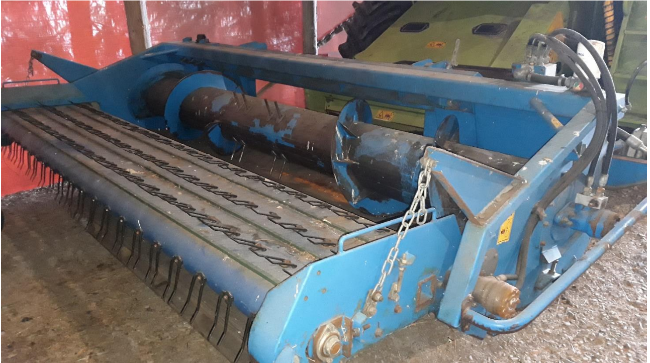
Kuva 11 Herneen ja muiden hitaasti tuleentuvien kasvien kaksivaihepuintiin tarkoitettu noukinpöytä (Timo Lötjönen, 2023)
