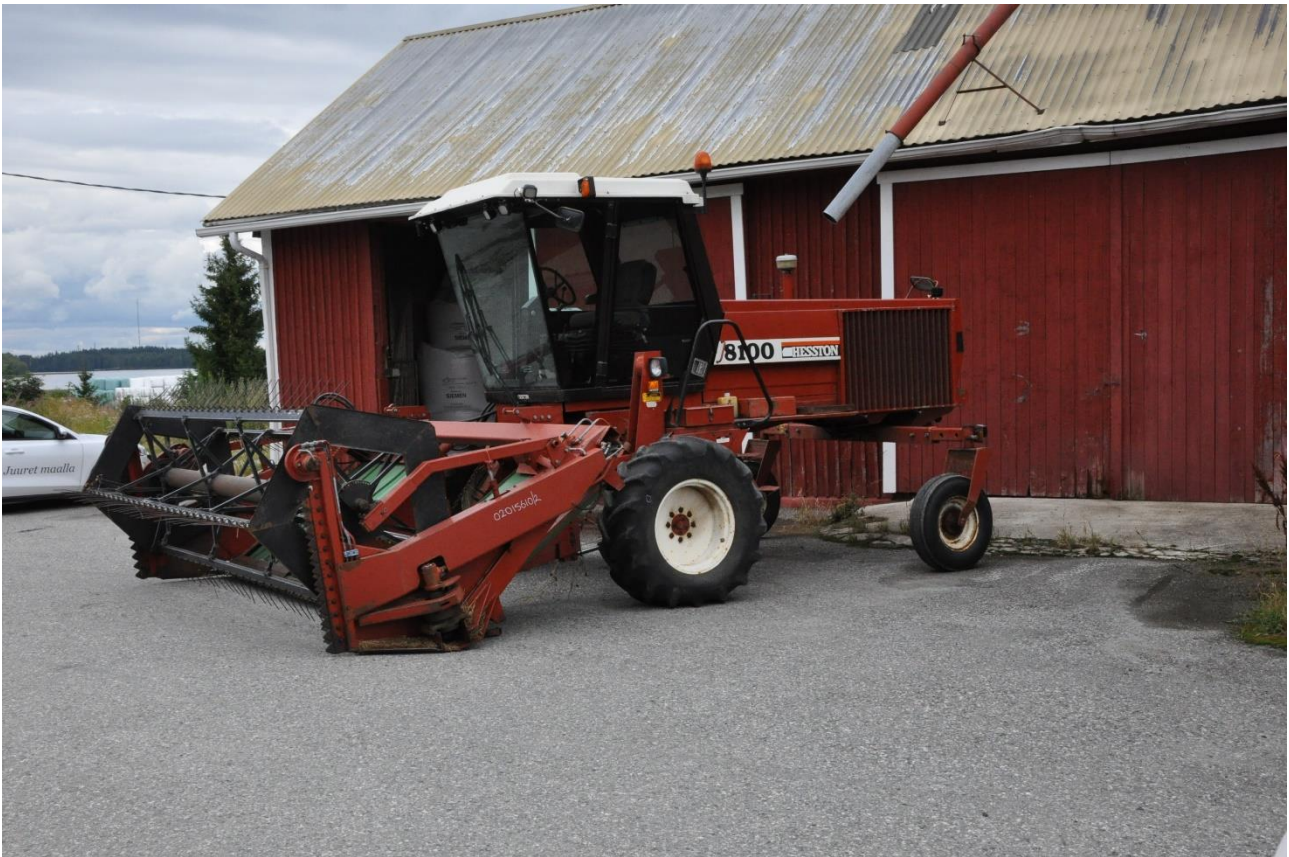
Kuva 12 Herneen ja muiden hitaasti tuleentuvien kasvien kaksivaihepuintiin tarkoitettu ajettava niittokone (Timo Lötjönen, 2023)
