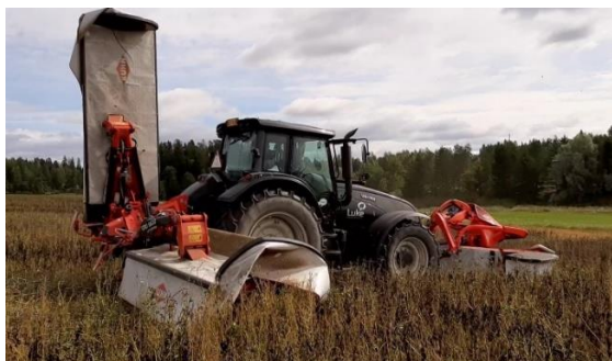
Traktorikäyttöinen lautasniittokone, n.s. perhosyhdistelmä etu- ja takakoneineen
