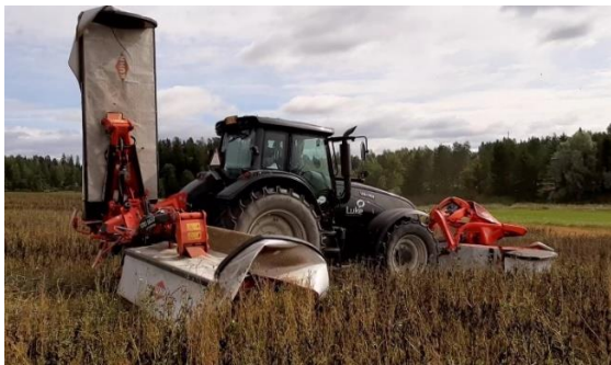
Traktorikäyttöinen lautasniittokoneyhdistelmä etu- ja takakoneineen. Takakone on n.s. perhosniittokone.
