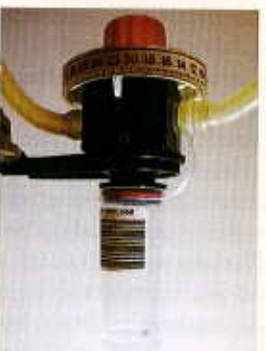
▲ Saranakannellista näytepikaria voi käyttää Tru-Testin maitomittarien näytteenottolaitteissa, kunhan niihin vaihdetaan sopiva tiiviste.
