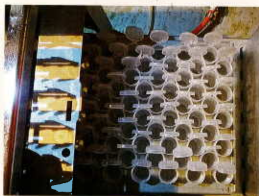
▲ Shuttle-näytteenottolaitteessa on tärkeää tarkastaa huolellisesti laitteen luukua suljettaessa, että kaikkien pikarien kannet ovat avoimina, pystysuorassa ja etteivät ne ole viereisen pikarin täytön esteenä.
