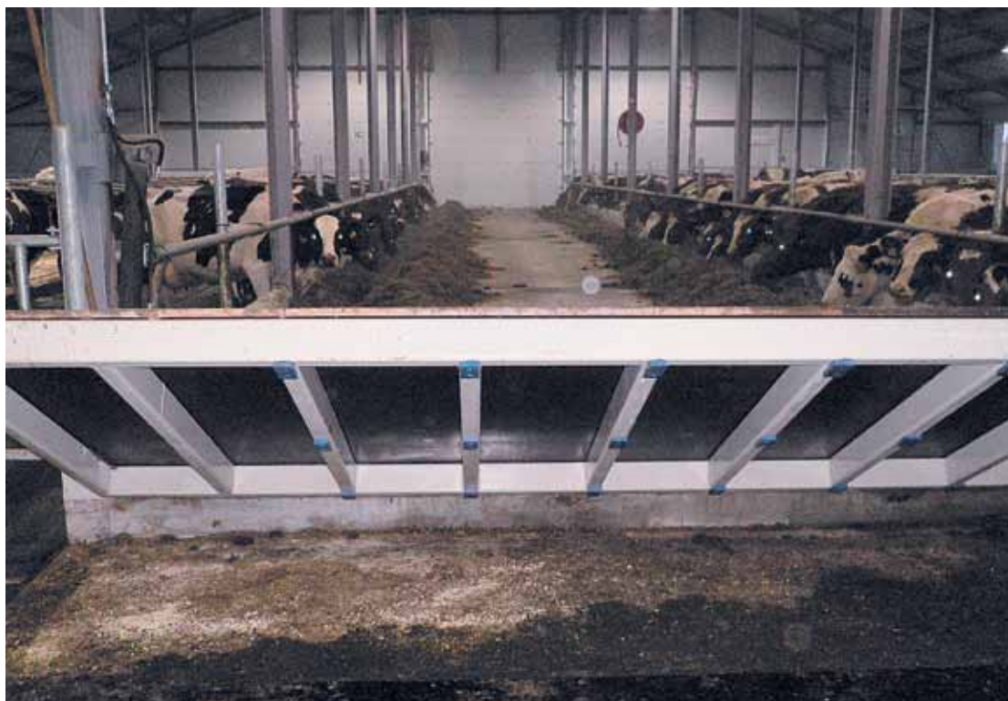
Гидравлически поднимаемый и опускаемый мост через кормовой стол, по которому коровы идут на дойку.
